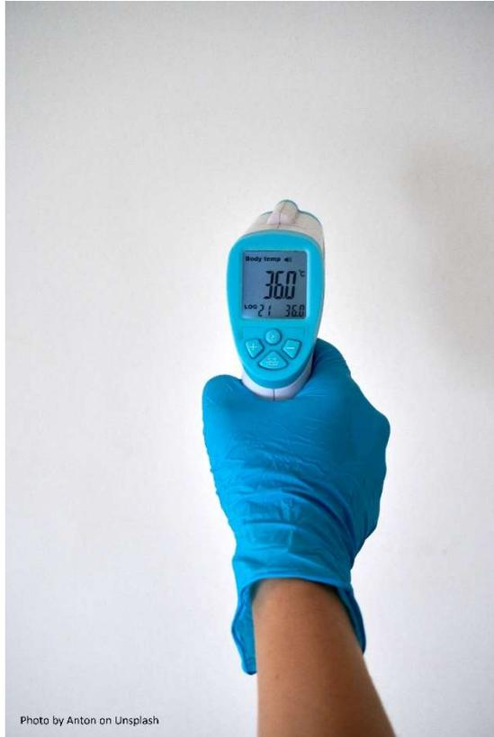
Estos termómetros son unos termómetros de radiación diseñados para medir la temperatura de la piel en la zona de la frente o de la sien. Las lentes que llevan asociadas nos proporcionan un margen de distancia para realizar la medida que suele oscilar entre unos pocos centímetros y medio metro (se establece en las especificaciones técnicas de cada termómetro).
